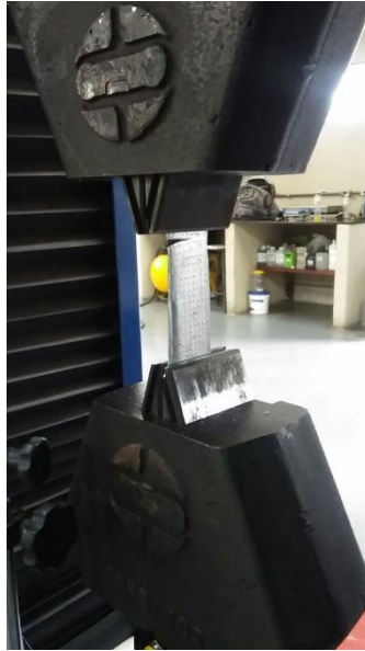
Figura 1 – Momento de ruptura do corpo de prova
