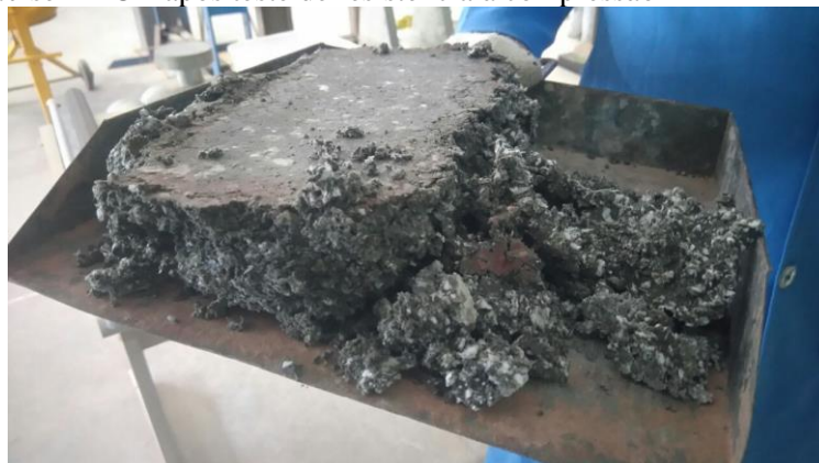
Figura 2. Papercrete sem RCD após teste de resistência à compressão
