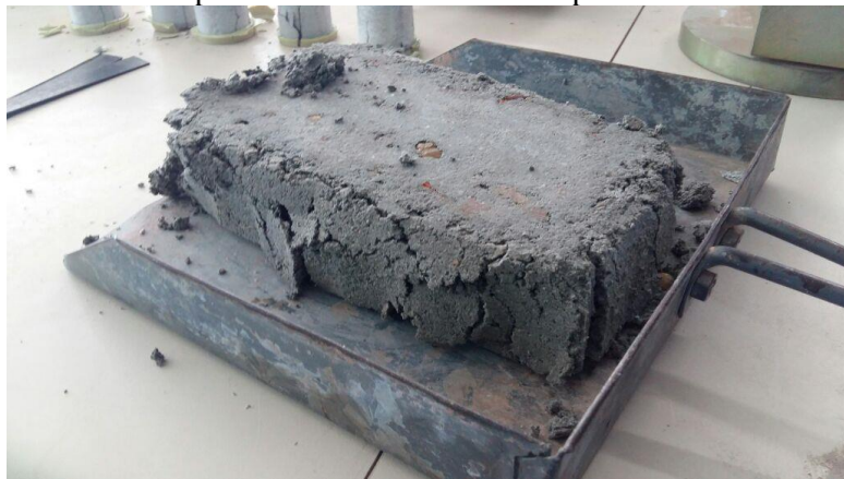
Figura 3. Papercrete com RCD após teste de resistência à compressão
