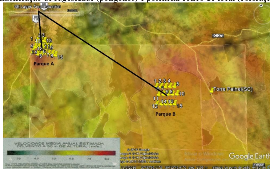
Figura 1 - Posicionamento dos parques com linhas de conexão elétrica e torre de medição, classificação de rugosidade (polígonos) e potencial eólico do local (coloração).
