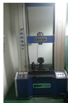
Figura 1 - Máquina de ensaio Universal Marca Versat de série M11-3009
