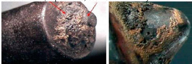
Figura 1. Problema de corrosão (coqueamento) ocorrido em bicos injetores de motores diesel
