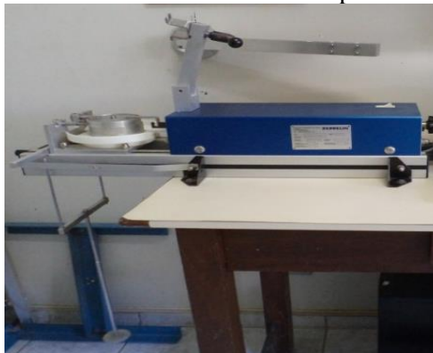
Figura 1. Célula de cisalhamento direto e aparelho TSG 70-140
