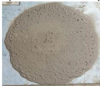
Figura 2. Vista superior do espalhamento do concreto após o ensaio slump flow test .
