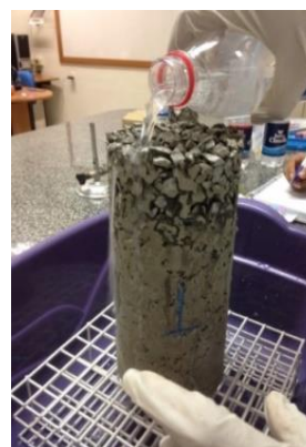
Figura 1: Diferença de peso dos corpos de prova (antes e após filtração dos diferentes tipos de água).
