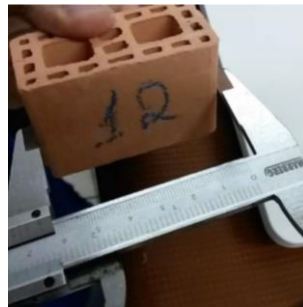
Figura 1. Bloco padrão em escala reduzida utilizado
