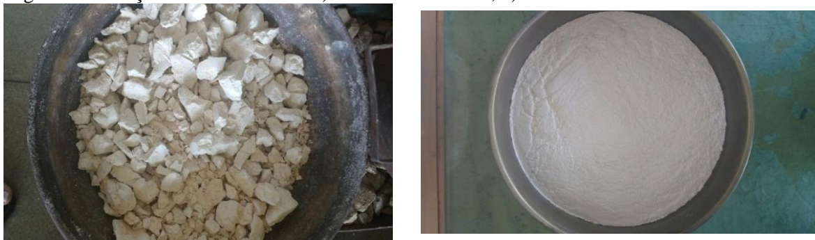
Figura 2. Produção da metacaulinita. a) Material em torrões; b) material calcinado
