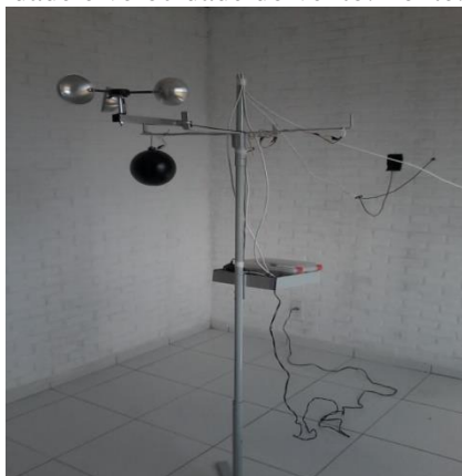
Figura 03 - Estação meteorológica composto de arduíno tipo Mega e sensores para obtenção e dados de temperatura, umidade e velocidade do vento. Fonte: os autores
