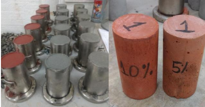
Figura 3. Moldagem e desmoldagem dos corpos de prova
