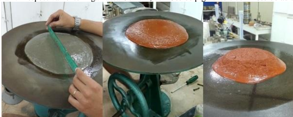
Figura 2. Respectivamente Argamassa Comum; com 5% de pigmento e com 10% do aditivo.
