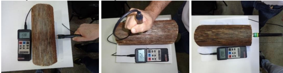
Figura 1. Utilização do ultrassom na medição.
