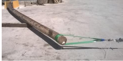
Figura 2. Ensaio de flexão em laboratório para postes de madeira.
