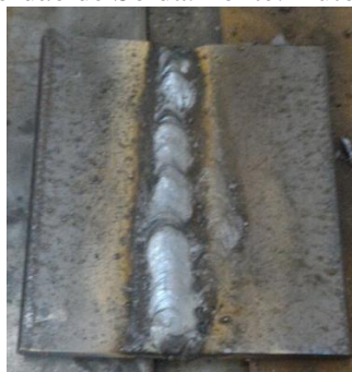
Foto 2. Cordão de Solda. Fonte: Autoria Própria
