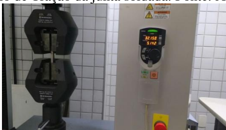
Foto 4. Ensaio de Tração da junta soldada. Fonte: Autoria Própria
