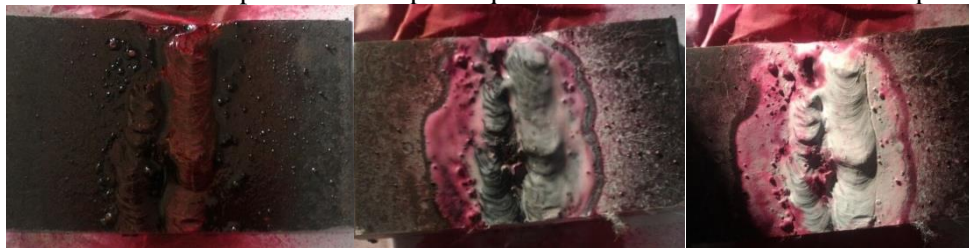
Foto 3: As três etapas do Ensaio por Líquido Penetrante. Fonte: Autoria Própria
