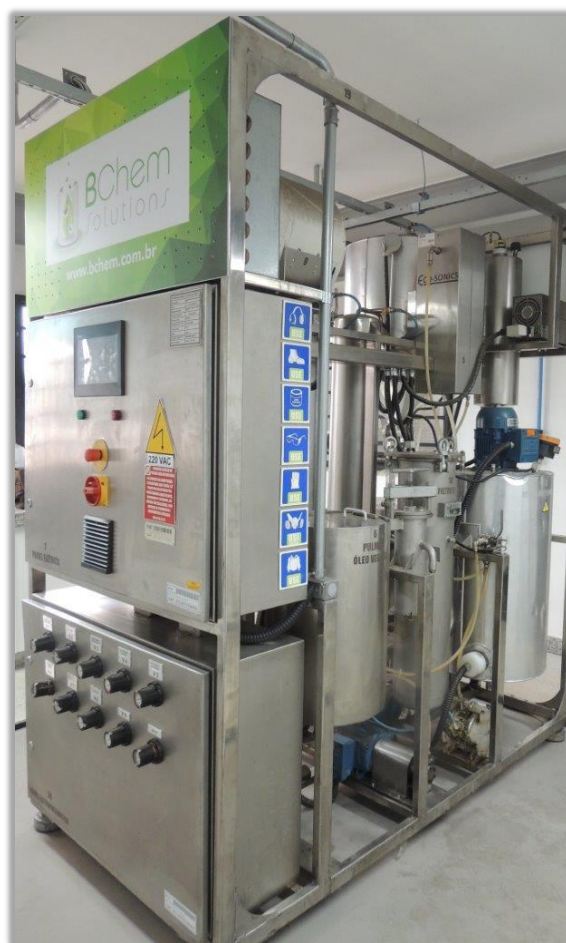
Figura 2. Planta piloto de biodiesel dotada de reator ultrassônico.
