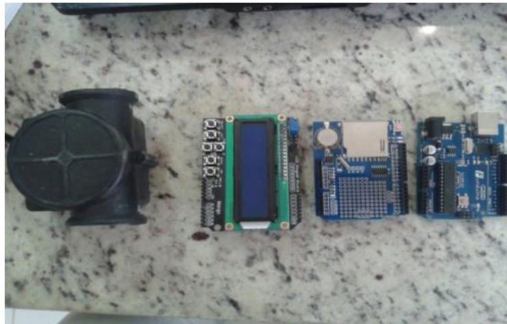
Figura 2. Equipamentos utilizados. Sensor de fluxo, display LCD, Shield de armazenamento e Arduino Uno, respectivamente.
