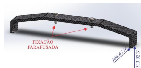
Figura 6: Detalhes da fixação.
