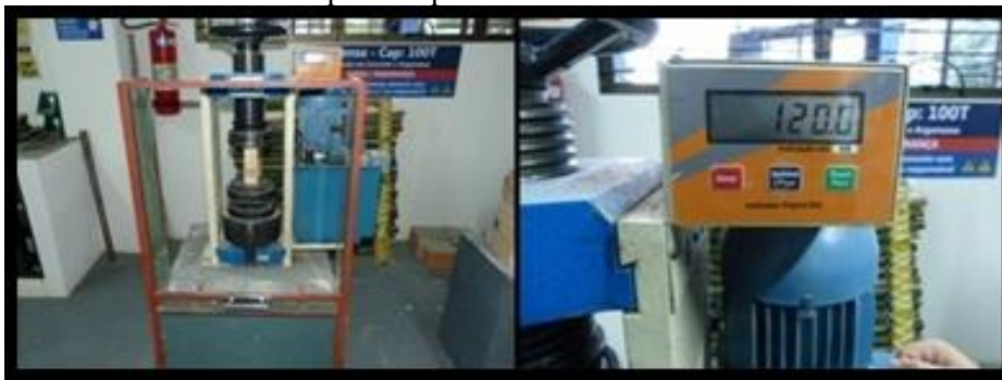
Figura 1. Ensaio de resistência à compressão paralela às fibras.
