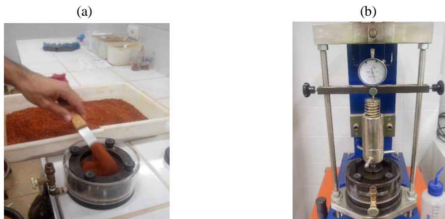
Figura 1. (a) Montagem do corpo de prova na célula de adensamento; (b) Prensa de adensamento.
