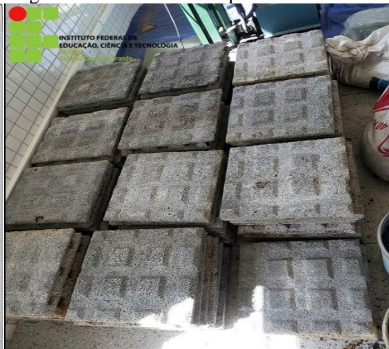
Figura 3. Blocos de EVA para telhado
