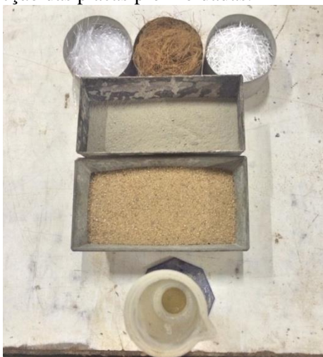
Figura 1. Materiais para a confecção das placas pré-moldadas.
