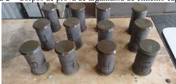
Figura 2 – Corpos de prova de argamassa de cimento capeados
