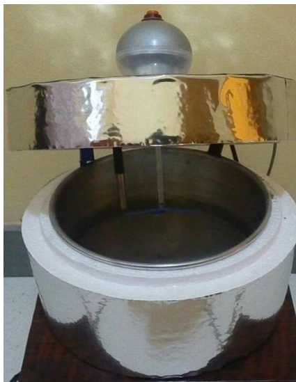
Figura 1. Vaso calorimétrico, agitador e sensor de temperatura.
