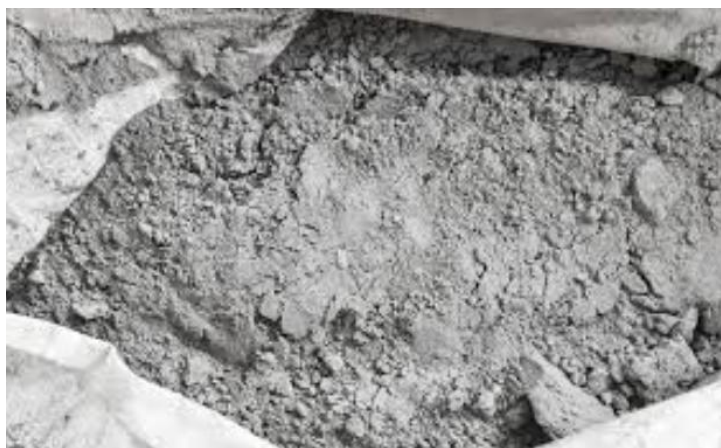
Figura 21. Cimento Portland de baixo carbono.
