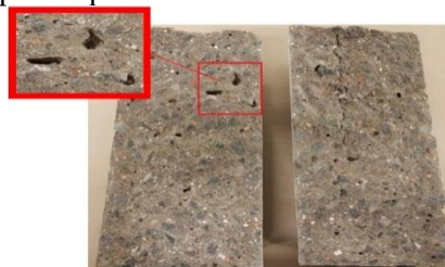
Figura 2 – Corpos de prova com bolhas de ar visíveis após a cura.
