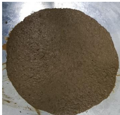
Figura 1 – Ensaio de espalhamento (slump flow) do concreto com 50% de areia reciclada.
