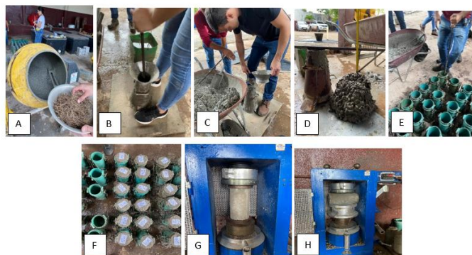
Figura 2. Preparação do traço de concreto e ensaios.
