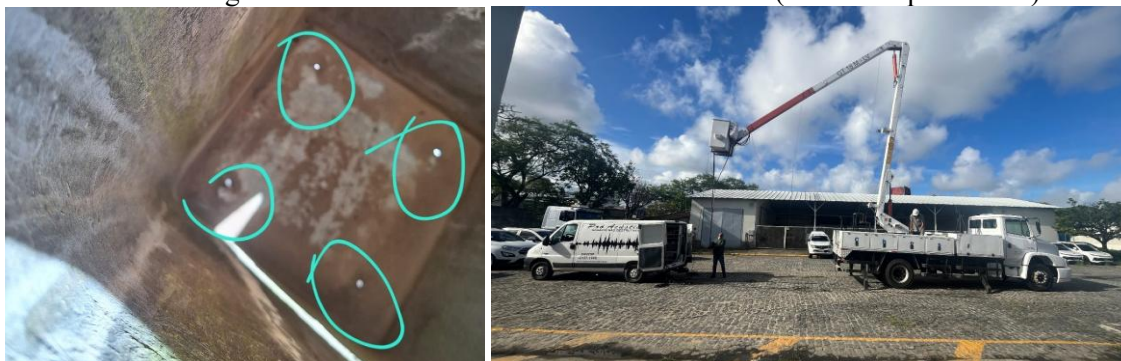
Imagem 4: Cesto aéreo com furos na sua estrutura (Fonte: Próprio Autor)
