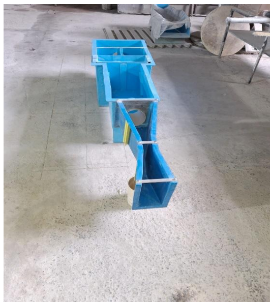
Figura 5: Sistema Preliminar com grade e caixa de areia e Medidor Vazão -Pàrshal 1 Pol
