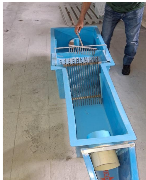
Figura 5: Sistema Preliminar com grade e caixa de areia e Medidor Vazão -Pàrshal 1 Pol
