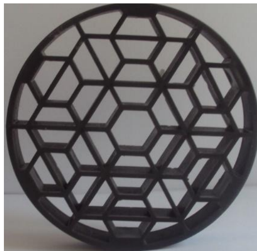
Figura 4: Mídia Plástica 420m 2 /m 3 - Diâmetro: 80mm, Altura 12,5 mm
