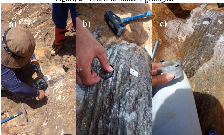
a) Etapa de perfuração; b) Retirada do plug de rocha; c) Amostra final
