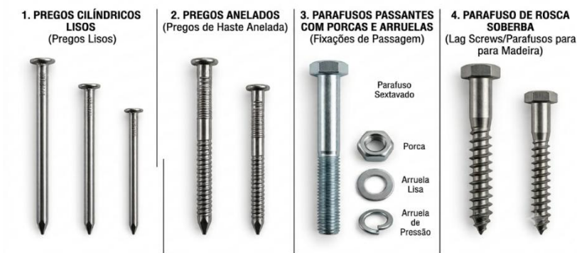
Figura 1: Principais tipos de pinos metálicos
