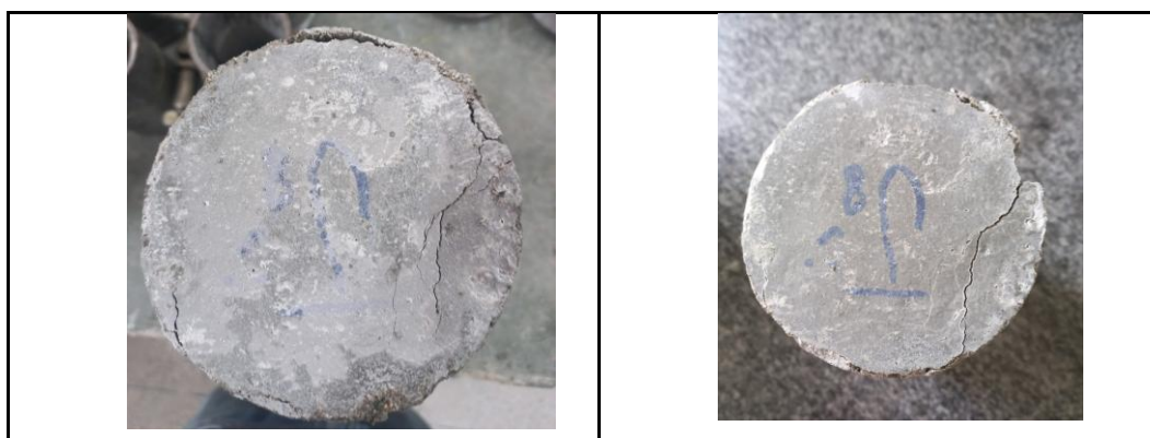
Figura 2 - Evolução das fissuras da base do cp IV aos 14 dias com 0,8% do aditivo
