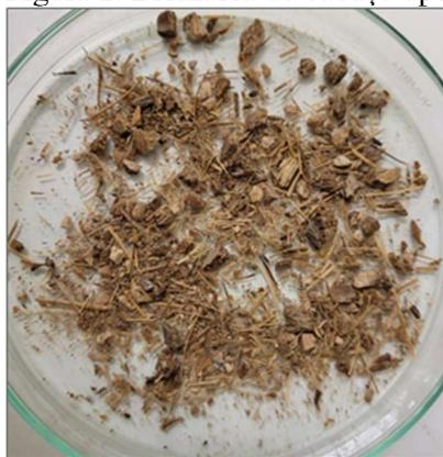
Na análise de distribuição granulométrica foi verificado que o diâmetro médio das partículas de biomassa variou de 0,075 mm a 4,760 mm, sendo o maior percentual de partículas, 34,50% da biomassa, referente a partículas com diâmetro médio de 3,570mm. Os resultados das análises de caracterização da biomassa são encontrados na Tabela 1.
