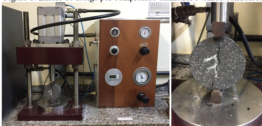
Figura 1: Ensaio de fadiga por compressão diametral à tensão controlada
