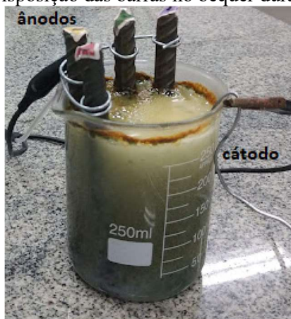
Figura 1: Disposição das barras no béquer durante o ensaio
