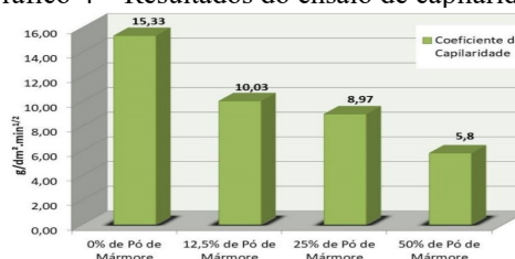
Gráfico 4 - Resultados do ensaio de capilaridade
