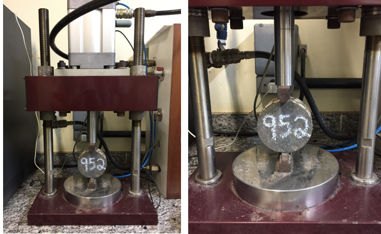
Figura 1: Equipamento para ensaio de fadiga por compressão diametral
