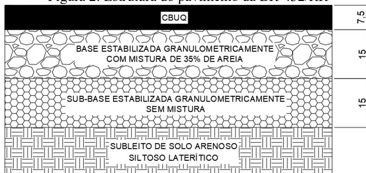
Figura 2: Estrutura do pavimento da BR-432/RR
