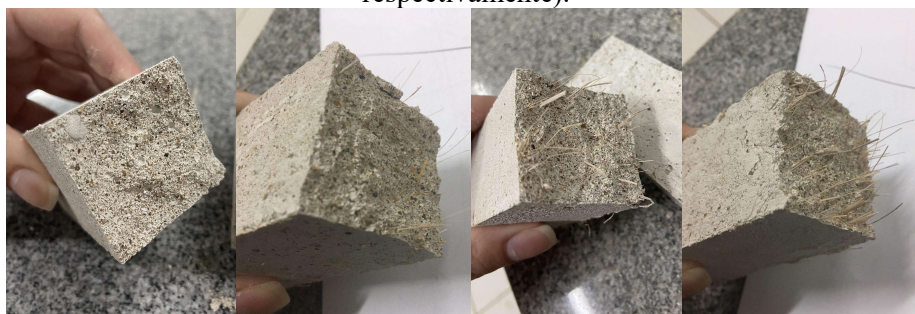
Figura 1. Seção dos CP's com diferentes teores de fibra de bananeira (AR1, AR2, AR3 e AR4, respectivamente).
