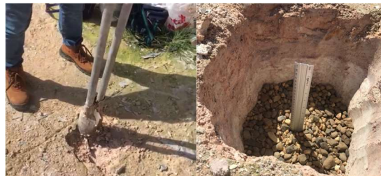
Figura 4: Escavação com boca de lobo e vala com seixo pronta para iniciar o ensaio. Fonte: Os autores.
