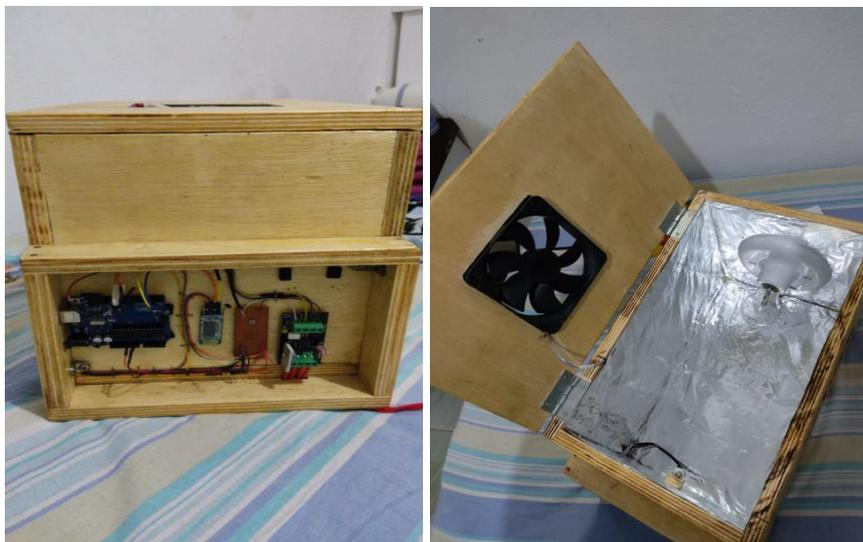
A supervisão remota do processo foi implementada por meio do aplicativo Bluetooth Terminal HC-05 disponível na Play Store Google, onde o usuário pode baixar e instalar no seu dispositivo móvel, em seguida fazer o pareamento do celular com o módulo HC-05 que está conectada a bancada didática.
