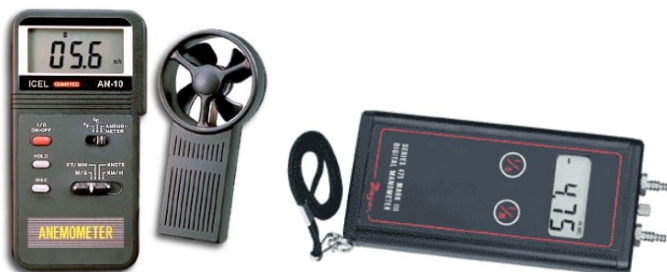
Figura 4 – Anemômetro e de manômetros diferenciais utilizados nas medidas de vazão e de pressão in loco .
