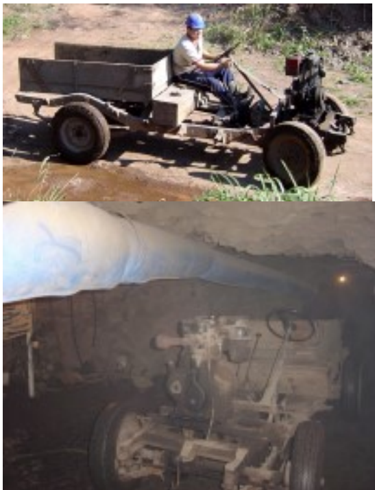
Figura 1 – Veículo de transporte de materiais típico nos garimpos. A) sob condições externas. B) sob condições subterrâneas (nas galerias).
