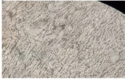
Figura 1 – Microscopia da liga de alumínio naval ampliada em 250X
