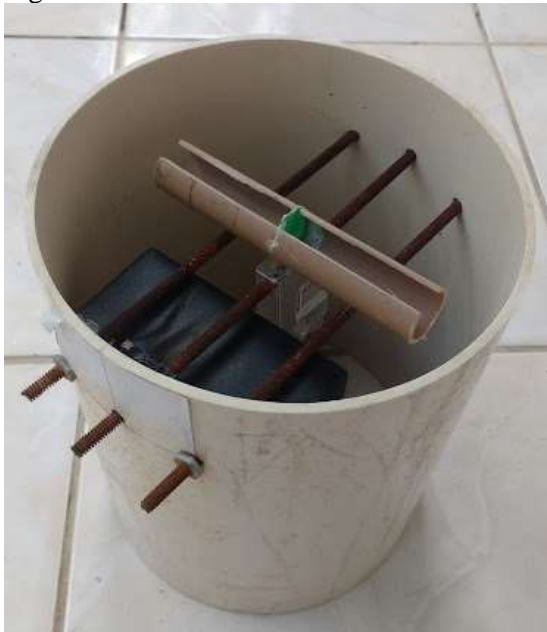
Figura 3: Base montada com a caixa dos circuitos e a balança.
