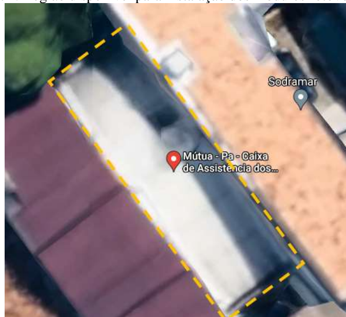
Figura 4. Região disponível para instalação dos módulos fotovoltaicos.
