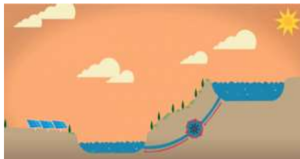
Fig. 4. Esquema de uma usina hidráulica reversível combinada com energia solar.
