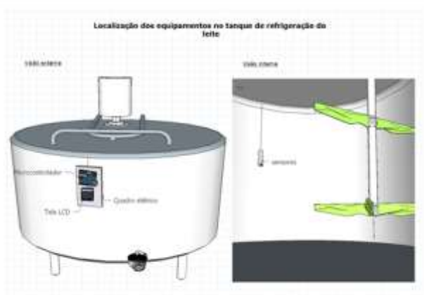
Figura 1 – Detalhes da instalação da sonda de medição no tanque de refrigeração do leite.
