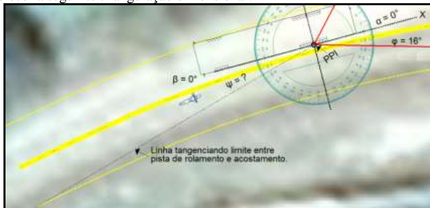
Figura 04- Triangulação dimensional com a motocicleta invadindo a pista do ônibus.
