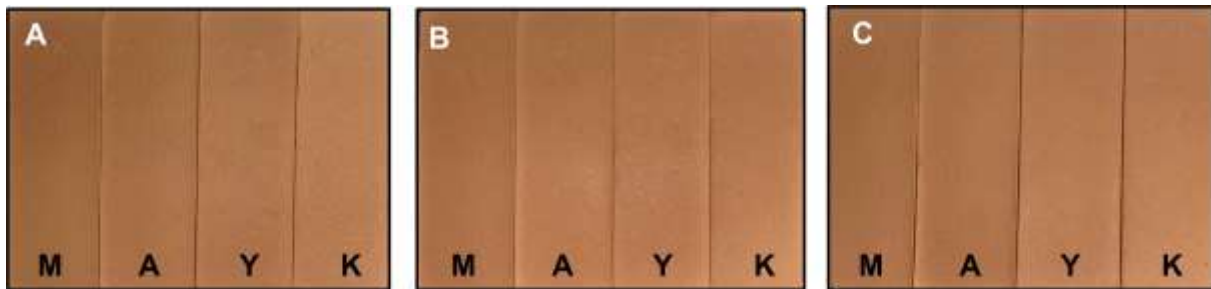
Figura 3. Coloração dos corpos de prova após a queima em 800°C, 900°C e 1000°C.
