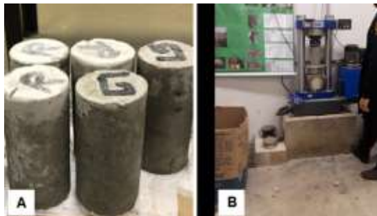
Figura 2. Corpos de prova sendo submetidos ao ensaio de resistência
