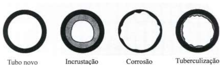
Figura 1 – Alterações na superfície interna do tubo (Azevedo Netto, 1998):
