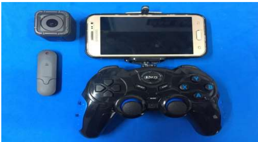
Figura 3. Sistema de Controle Remoto do Robô.
